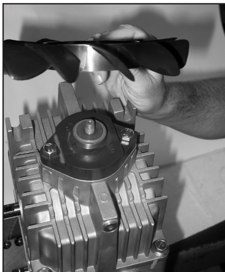
Place fan on spacer
